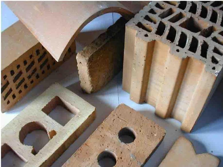
Distintos bloques de arcilla cocida, biocompatibles y aptos para construcción ecológica aunque con mayor huella ecológica que la tierra cruda.
