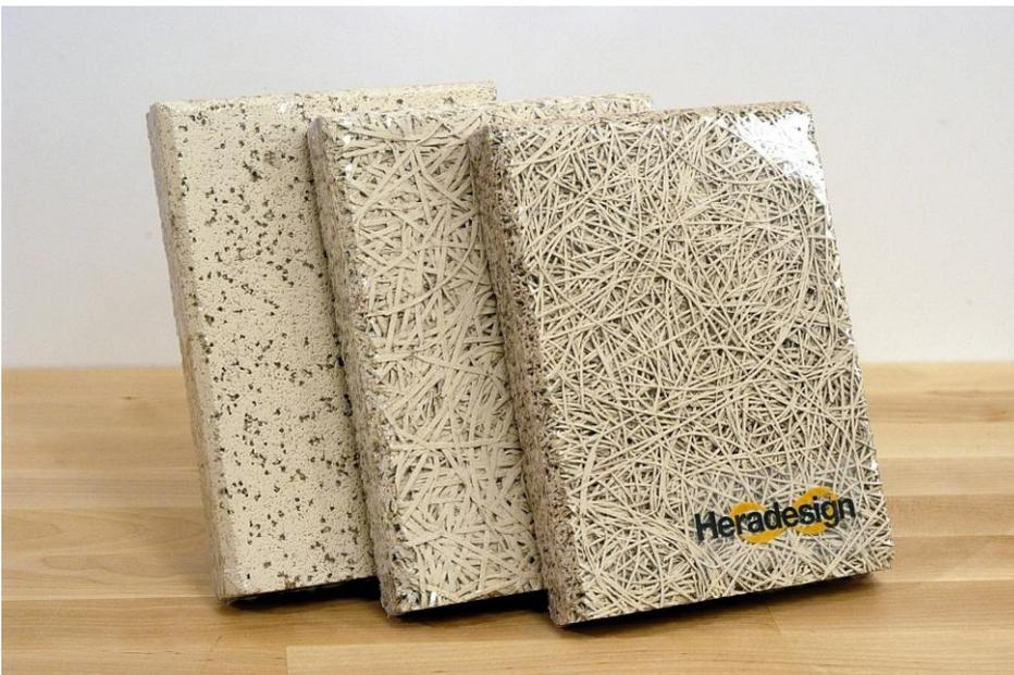
Placas de hilos de madera mineralizada y compactada con magnesita o cemento.
