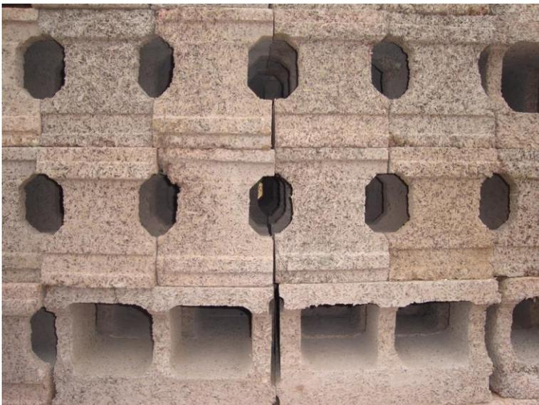
Bloques de fibra de madera mineralizada y cemento portland, alternativa intermedia hacia una construcción más sostenible.
